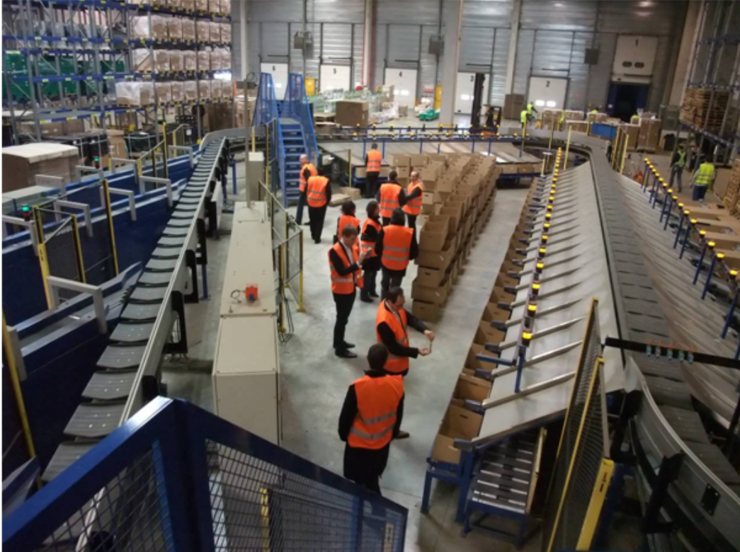
Vue générale du carrousel. Une partie des 60 goulottes fournisseurs est visible à droite.
