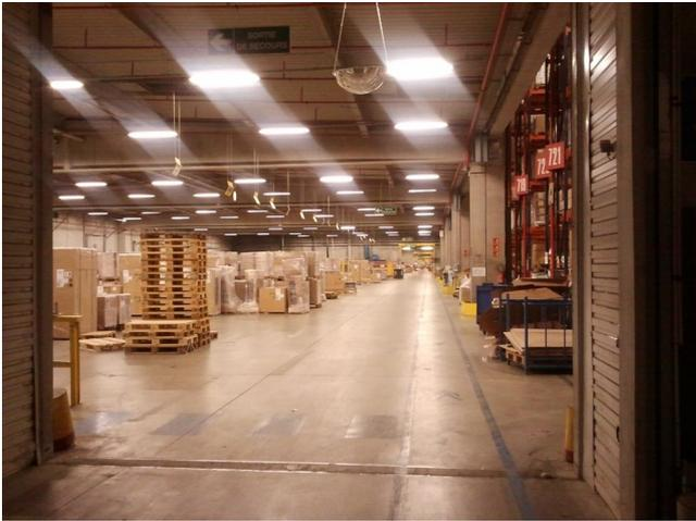
**L'entrepôt mesure plus de 900m de long**, ce qui justifie l'usage de vélos pour s'y déplacer ! Il est organisé en 8 modules : 4 modules classiques de 13m de haut et 4 modules silos de 18m en transstockeur.
